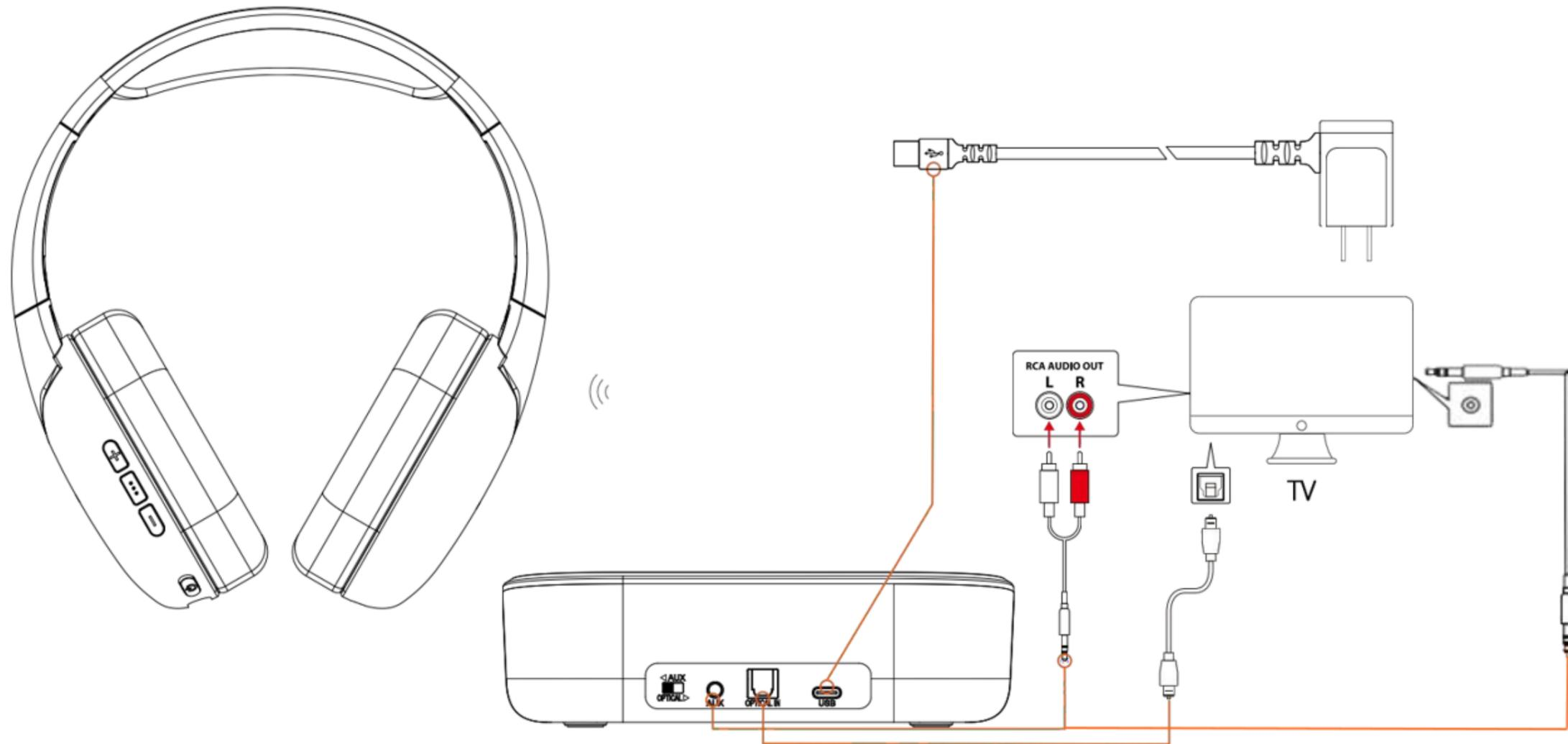
Utilice el adaptador Tipo-C para conectar la estación base a la fuente de alimentación
